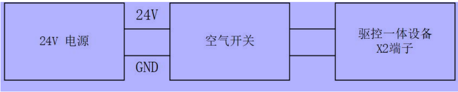
图 4.4 控制回路供电接线建议图
